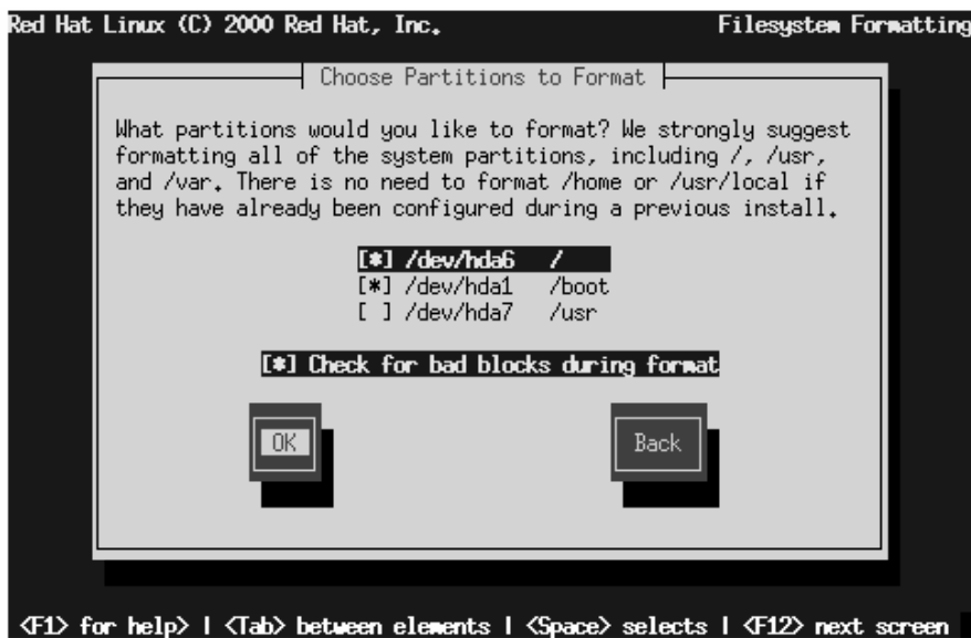
Figure 14–20 Choix des partitions à formater
