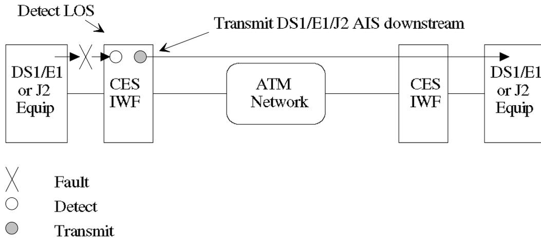
**Figure 3-2: Unstructured DS1/E1/J2 Service Interface Fault Indication**
