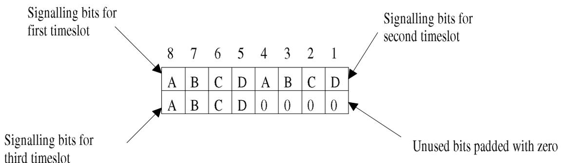
**Figure 2-8: Example DS1/ESF and E1 Signalling Substructure**
